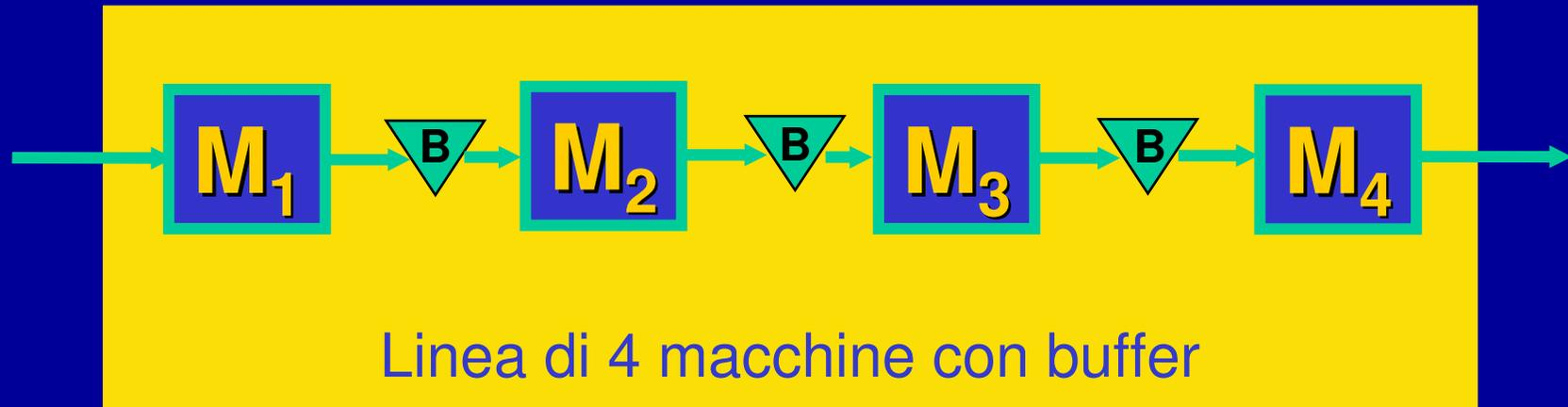
Per minimizzare il tempo di completamento  $C_m$  si usa una griglia di divisione in cui le zone proibite riguardano le macchine
