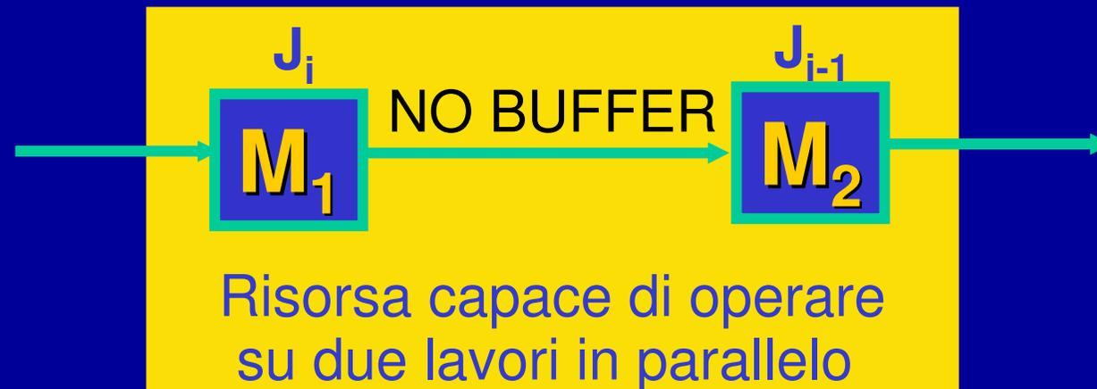
Per minimizzare il tempo di completamento  $C_m$  degli  $n$  lavori (tutti disponibili in ingresso:  $r_{i1}=0$ ) si può applicare Gilmore e Gomery, attribuendo ad ogni lavoro  $J_i$  stato di inizio  $a_i$  e stato di fine  $b_i$
